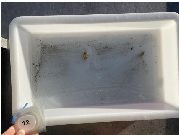
Figur 17: Bilder som viser grabbinholdet fra stasjon 12. Sedimentet besto av sandstrø over fjellbunn. Foto: Aqua Kompetanse AS.
