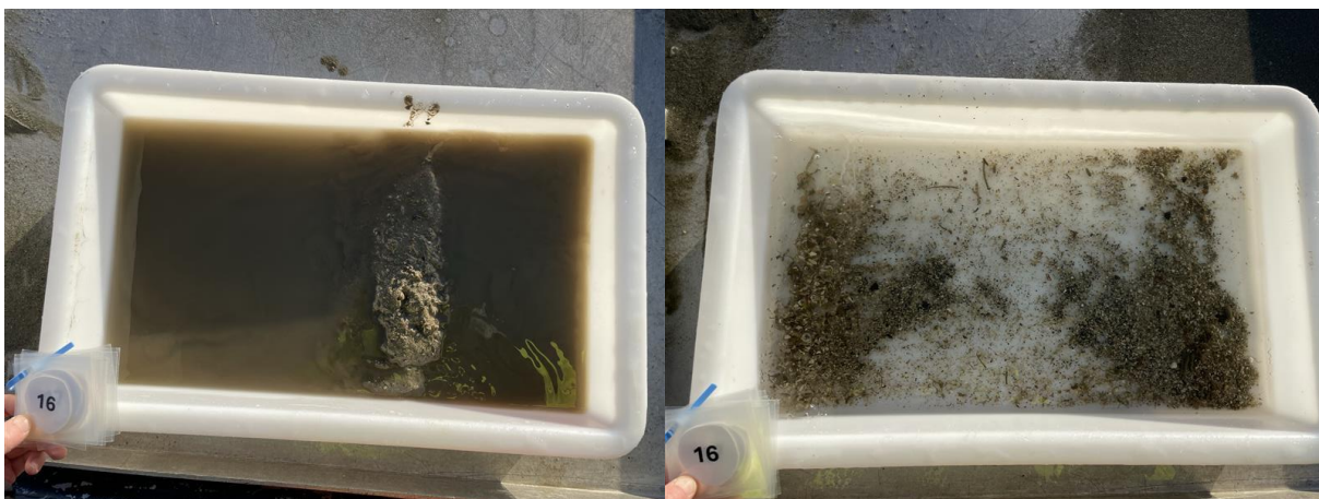
Figur 21: Bilder som viser sedimentet fra stasjon 16 før og etter siling. Sedimentet besto av sand og skjellsand. Foto: Aqua Kompetanse AS.
