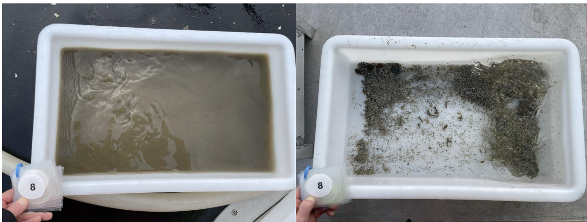
Figur 13: Bilder som viser sedimentet fra stasjon 8 før og etter siling. Sedimentet besto av sand, silt og skjellsand over steinbunn. Foto: Aqua Kompetanse AS.
