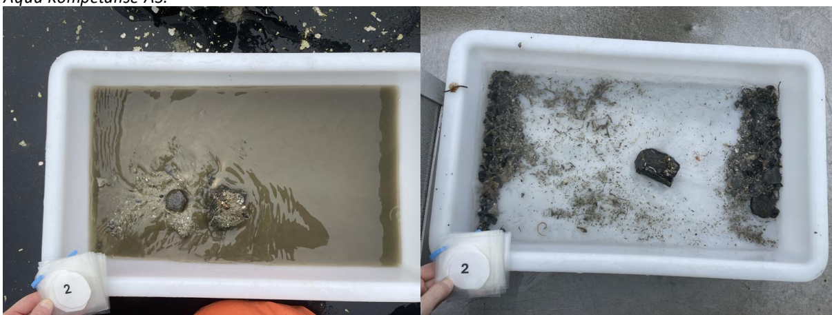
Figur 6: Bilder som viser sedimentet fra stasjon 1 før og etter siling. Sedimentet besto av silt, sand og skjellsand. Foto: Aqua Kompetanse AS.
