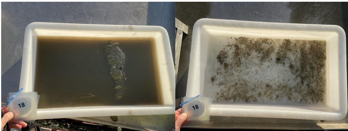
Figur 23: Bilder som viser sedimentet fra stasjon 18 før og etter siling. Sedimentet besto av sand og skjellsand. Foto: Aqua Kompetanse AS.
