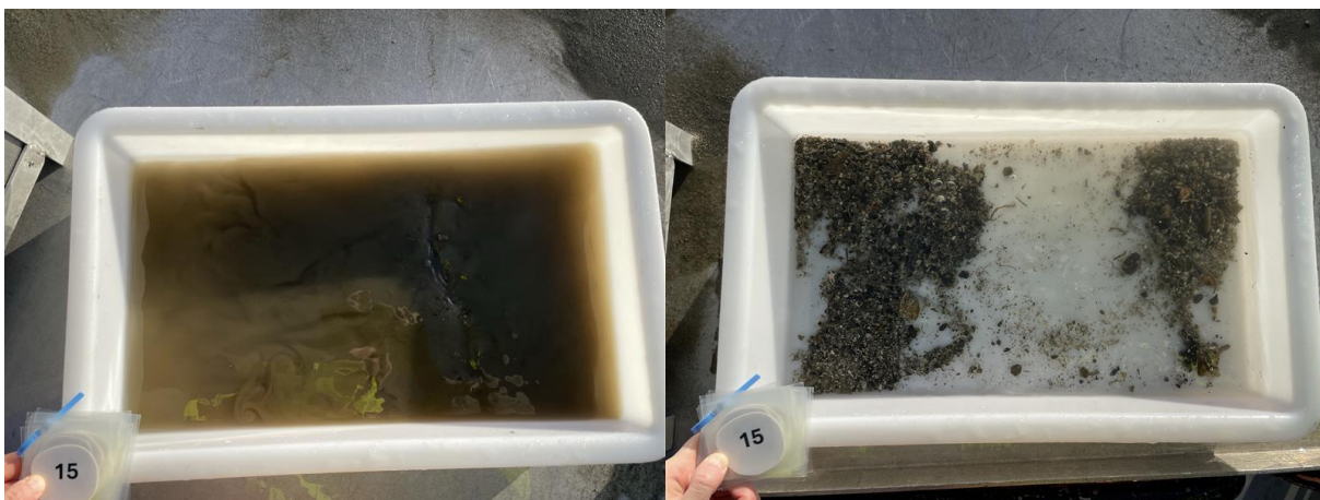
Figur 20: Bilder som viser sedimentet fra stasjon 15 før og etter siling. Sedimentet besto av sand og grus. Foto: Aqua Kompetanse AS.
