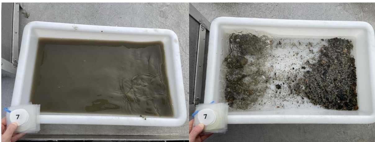
Figur 12: Bilder som viser sedimentet fra stasjon 7 før og etter siling. Sedimentet besto av sand og skjellsand over steinbunn. Foto: Aqua Kompetanse AS.
