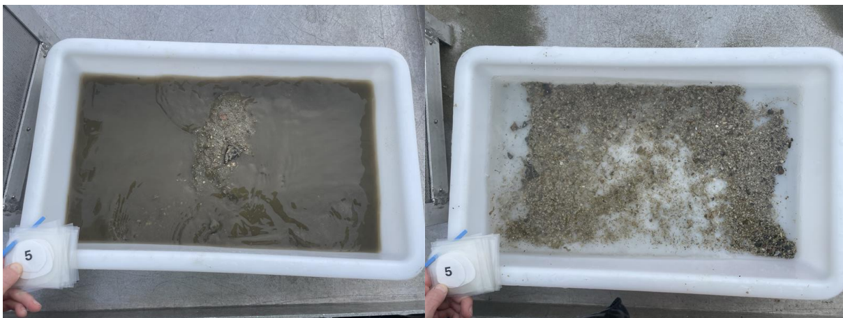
Figur 10: Bilder som viser sedimentet fra stasjon 5 før og etter siling. Sedimentet besto av silt, sand, grus og skjellsand. Foto: Aqua Kompetanse AS.
