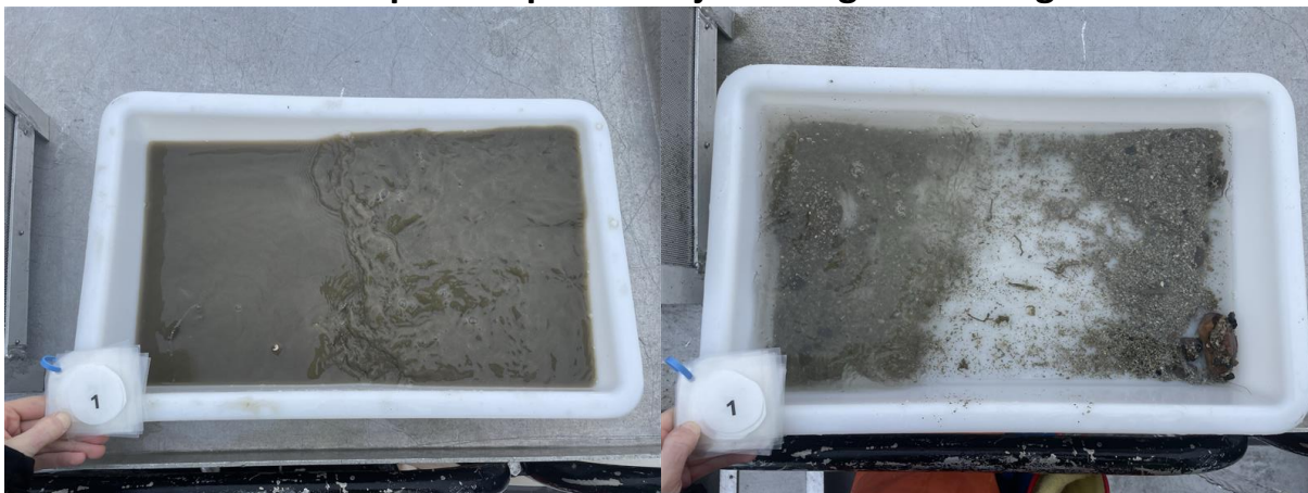
Figur 6: Bilder som viser sedimentet fra stasjon 1 før og etter siling. Sedimentet besto av silt, sand og skjellsand. Foto: Aqua Kompetanse AS.
