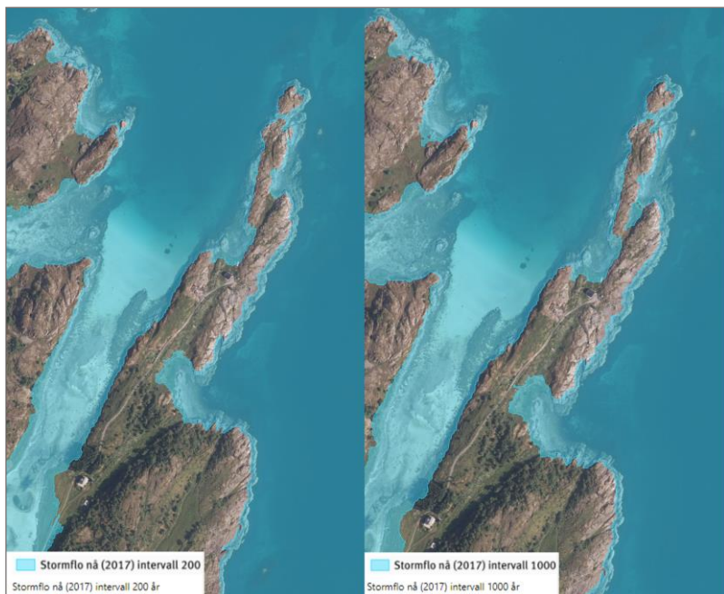
Figur 11: Kartverkets seahavnivå. Til høyre stormflo nå med 200 års intervall. Til venstre stormflo nå med 1000 års intervall.
